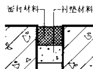
1 圆、方形衬垫密封材料做法
