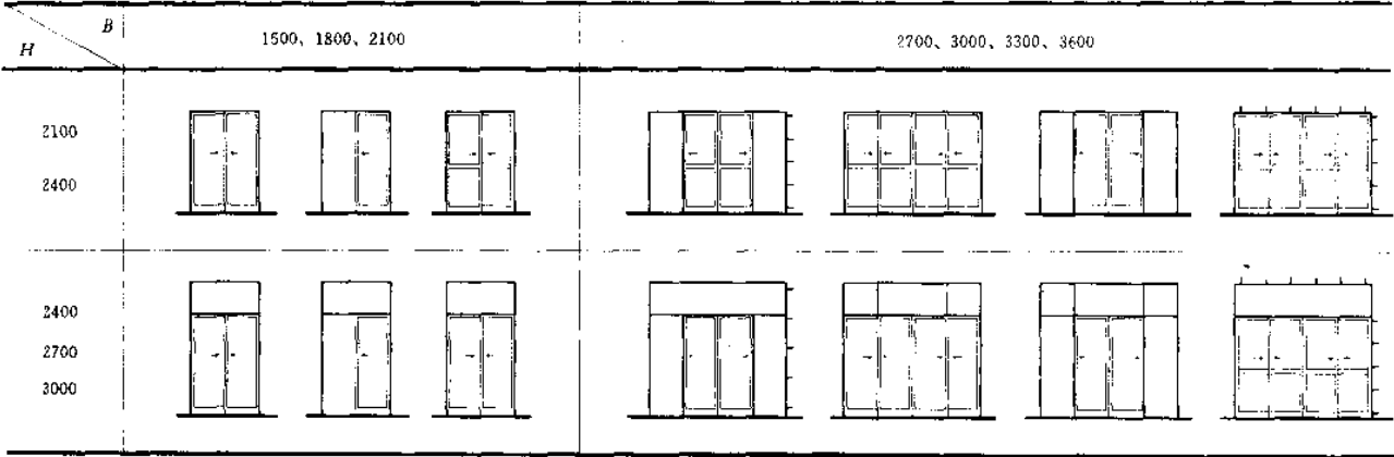
门型立面简图、洞口尺寸(mm)
