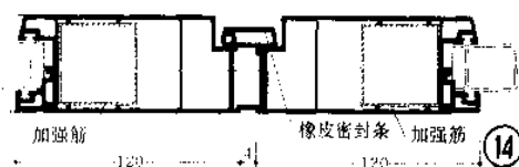
塑料构件衬加强筋的额定长度
