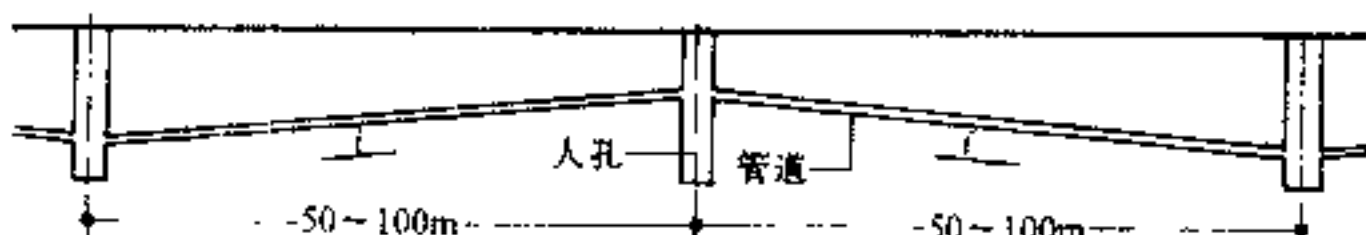
2 平地一字坡型管道敷设 i = 4\text{‰} \sim 5\text{‰}
