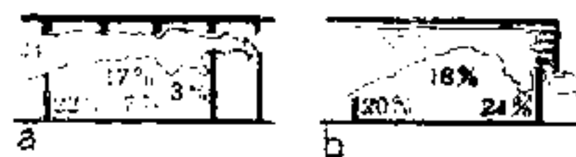
5 气流经过地区有阻碍时对气流速度的影响
