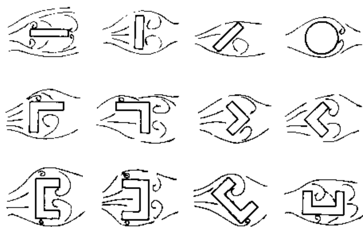
1 气流涡旋区产生的位置取决于建筑物的外形和风向，涡旋区大，正压亦大的部分，通风最有利，圆形建筑的涡旋区最小
