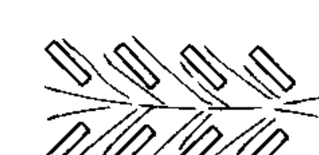
g 斜向布置导流好，形成了风的进口小出口大，可以加大流速，如建筑物的窗口再组织好导流，则有利于自然通风
