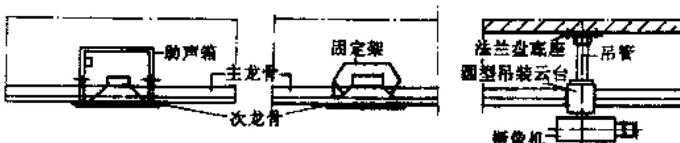
⑧ 扬声器在吊顶内嵌装
