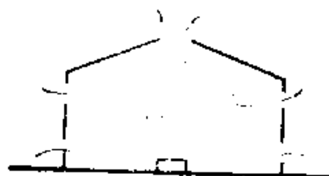
c 组织好气流, 使粉尘的气体上升在天窗处
